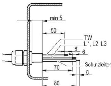
Abb. 1: Empfohlene Abmantelungslängen in mm (innerhalb Klemmkasten)
