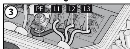
Иллюстрация 2: Подключение проводов к клеммам
