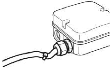
Abb. 2: Liegend eingebauter Ventilator, Verlegung des Kabels als Wassersack.
