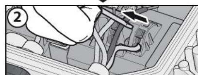
Иллюстрация 2: Подключение проводов к клеммам
