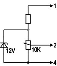
einstellbare Drehzahl über PWM 1-10 kHz
