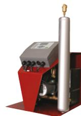
Вакуумная дегазация в эжекторе специальной конструкции является особо эффективной - почти независимо от температуры осуществляется полное удаление воздуха из циркулирующей воды и воды для подпитки.
