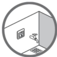
В помещениях с повышенной влажностью размещайте терморегулятор в соответствии с местными нормами по IP-классам.
