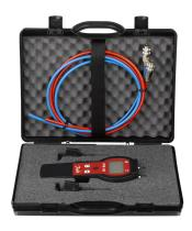
Прибор PFM 100 предназначен для измерения перепада давлений по обе стороны от клапана в гидродинамической системе.
