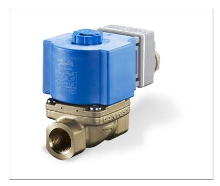
EV260B – это серия пропорциональных (регулирующих) двухходовых электромагнитных клапанов с сервоприводом с соединениями от 1/4 дюйма до 3/4 дюйма. Путем плавного регулирования тока катушки, якорь может быть перемещен в любое положение в якорной трубке, при этом плавно изменяется степень открытия и пропускная способность клапана от полностью закрытого до полностью открытого состояния. Когда ток катушки достигает максимального значения, клапан полностью открыт.
