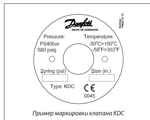
Пример маркировки клапана KDC
