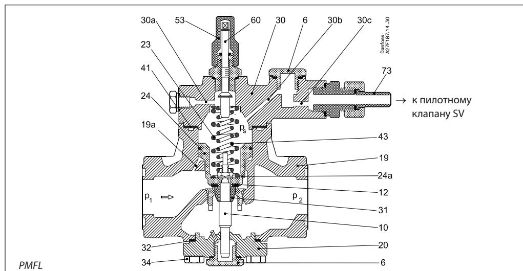
Падение уровня жидкости в поплавковой камере приводит к опусканию поплавка и открытию дросселя поплавка. При этом открывается проход для более высокого давления  $P_s$ , которое действует на верхнюю часть сервопоршня, на сторону низкого давления. Давление  $P_s$  уменьшается и регуля-
