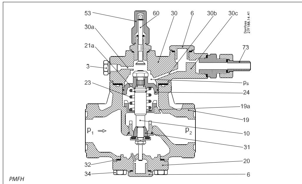
При увеличении уровня жидкости в поплавковом регуляторе SV канал пилотного дросселя открывается и пропускает давление через пилотную линию в верхнюю секцию регулятора PMFH. Давление  $P_s$  увеличивается и заставляет поршень двигаться вниз, открывая клапан регулятора PMFH. Пилотная линия соединена со штуцером SI, расположенным на верхней крышке регулятора PMFH. Коррекцию пилотного управления можно осуществлять с помощью клапана EVM, установленного в штуцере SII.
