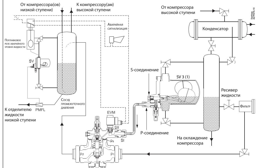
Система охлаждения с поплавковым регулятором высокого давления (приведена только в качестве пояснительной схемы)
