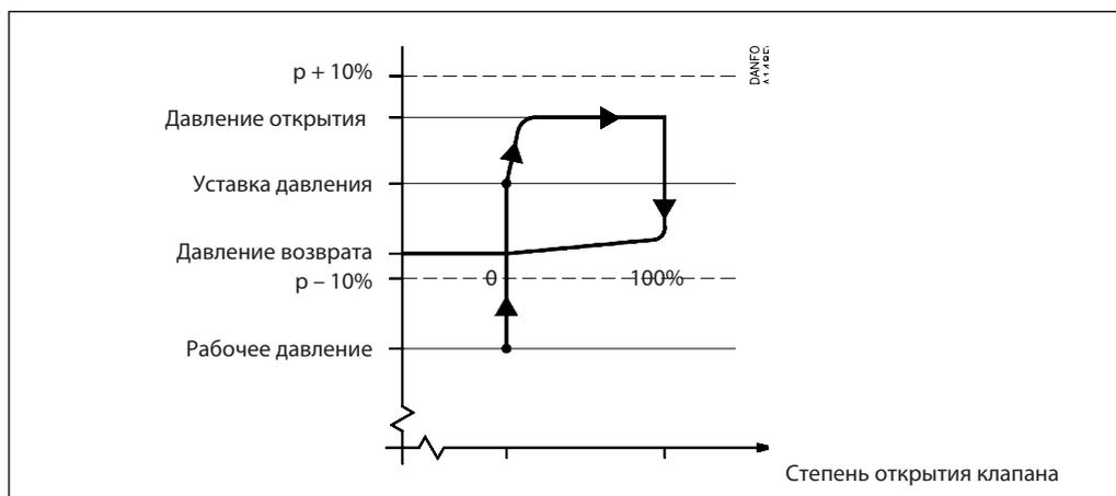
Клапаны SFV выпускаются как стандартные предохранительные клапаны (DIN 3320) для холодильных установок. При увеличении давления в системе выше уставки давления предохранительный клапан начинает открываться, сначала незначительно, чтобы пропустить минимальный расход хладагента.
