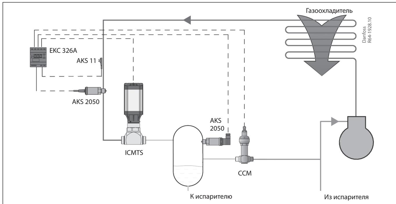
Клапаны ICMTS разработаны для применения в закритических системах на CO<sub>2</sub>. Клапаны ICMTS могут быть использованы в системах на линии перепуска горячего газа, параллельным сжатием, а также применяться автономно. Клапаны ICMTS могут быть использованы в закритических и подкритических условиях.
