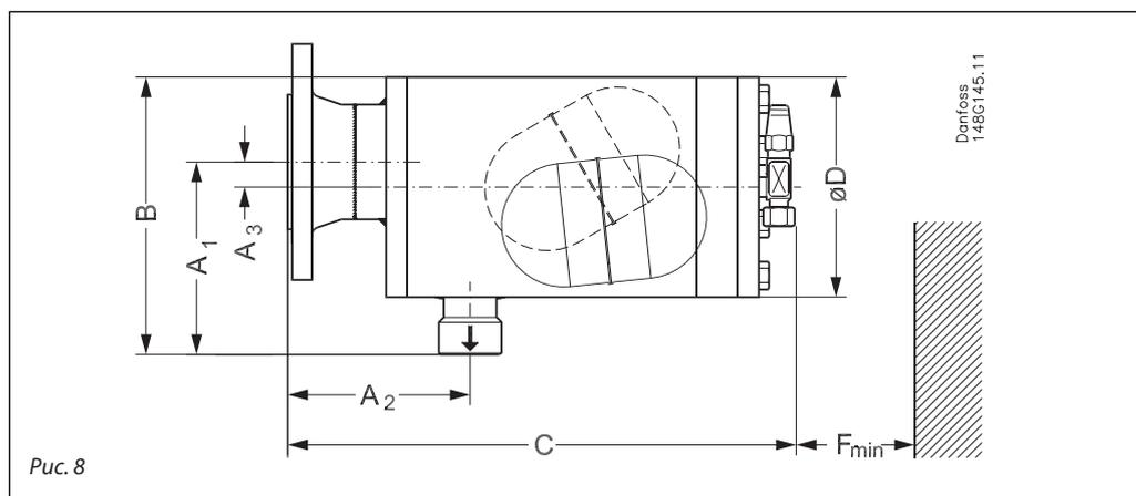
Поплавковый клапан высокого давления с фланцем (рис. 8)
