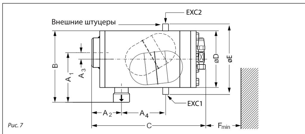
Поплавковый клапан высокого давления без фланца (рис. 7)
