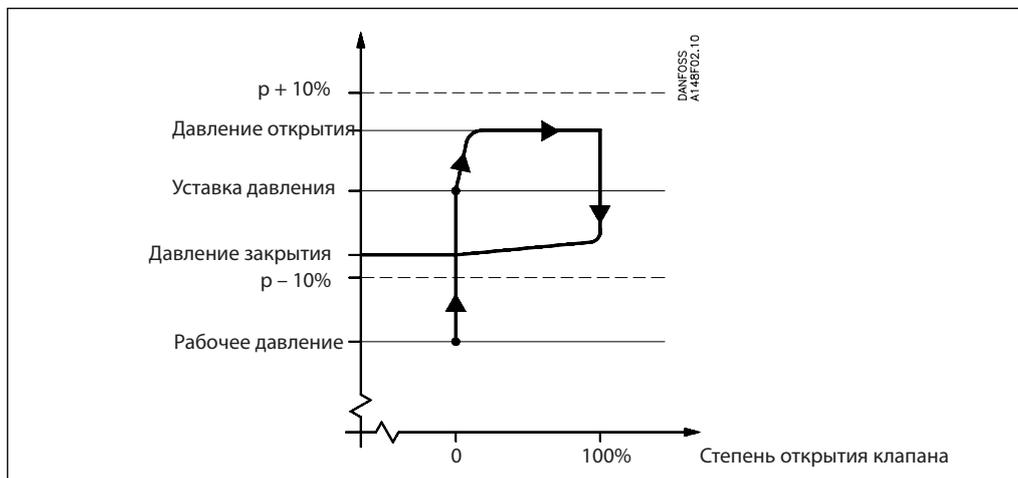
Клапаны BSV выпускаются как стандартные предохранительные клапаны (DIN 3320) для холодильных установок. При увеличении давления в системе выше давления настройки предохранительный клапан начинает открываться, сначала ненамного, чтобы обеспечить минимальный расход хладагента. Если давление в системе будет продолжать расти, клапан откроется полностью. Клапан полностью откроется до того, как
