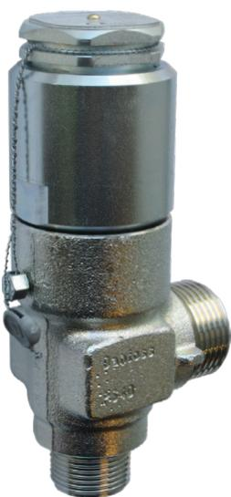
BSV 8— это **не зависящие** от противодействия стандартные предохранительные клапаны, предназначенные для защиты небольших компонентов системы охлаждения от слишком большого давления и для работы в качестве пилотов внутренних предохранительных клапанов типа POV.
