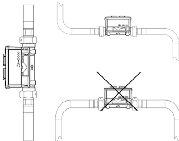
При установке преобразователя расхода на вертикальных участках трубопровода с нисходящим направлением потока необходимо обеспечить давление в трубопроводе не менее 1 Мпа (для сохранения сплошности измеряемой среды).
