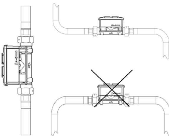
При установке преобразователя расхода на вертикальных участках трубопровода с нисходящим направлением потока необходимо обеспечить давление в трубопроводе не менее 1 Мпа (для сохранения сплошности измеряемой среды).
