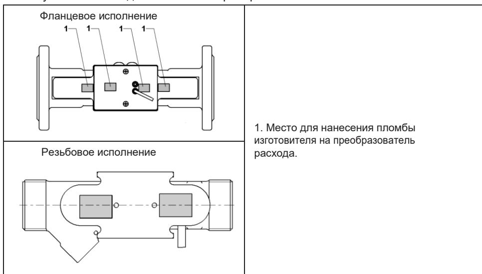
Места пломбировки электронного блока
