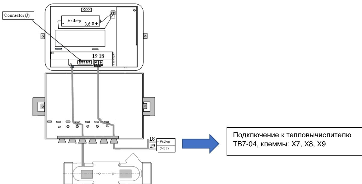
Схема электрического подключения расходомера при питании от внешнего источника 24 В.
