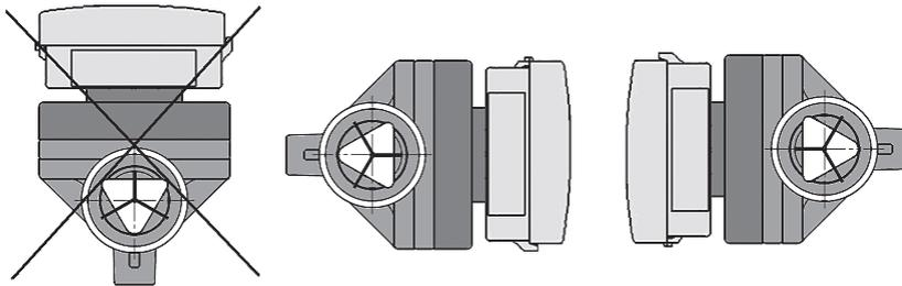
Преобразователь устанавливается между двумя фланцами и стягивается болтами (фланцы болты и гайки в комплект не входят).
