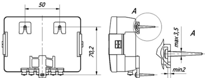
3) Установка непосредственно на расходомер (электронный блок должен быть повернут боком на 90°) допускается при температуре теплоносителя не более 90 °C.
