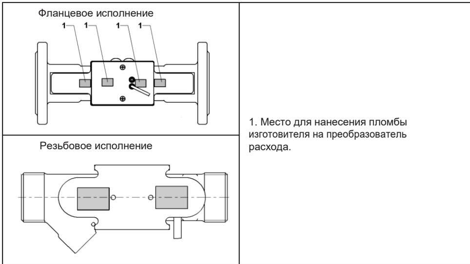
Места пломбировки электронного блока
