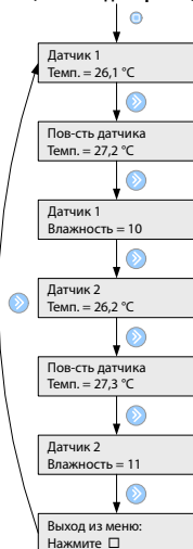
Просмотр показаний датчиков (Система для крыши)
