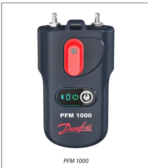
Расчет расхода через компонент (балансирующий клапан или измерительную диафрагму) осуществляется в приборе PFM 1000 на основе перепада давления, который определяется измерительным элементом системы. В приложении рассчитанный расход корректируется также
