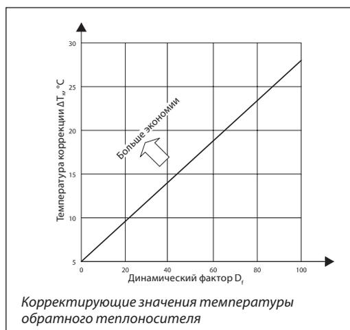
Настройка термоэлемента QT определяется разностью расчетной температуры обратного теплоносителя и найденным значением температуры коррекции (см. примеры).
