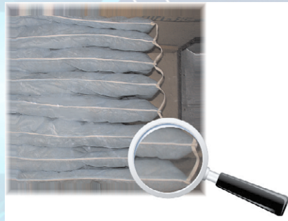
Рис.4 Фото во время испытаний карманного фильтра с постоянным зазором между карманами
