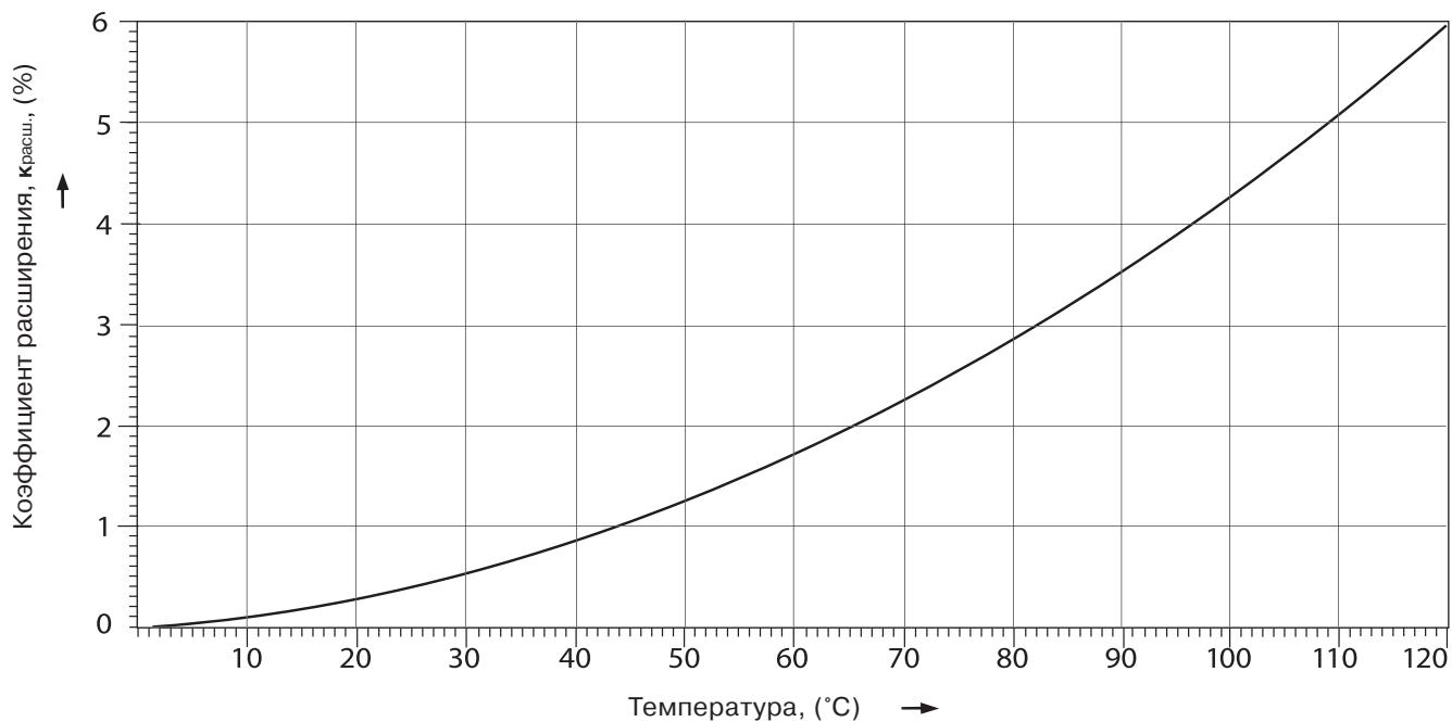
**Диаграмма температурного расширения смеси воды и этиленгликоля в % при ее нагреве (охлаждении) от 10 °C до средней температуры системы**
