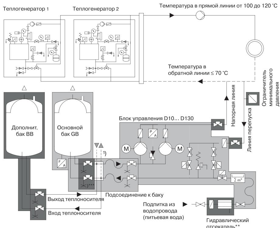
**Схема Flamcomat M01 (M02, M10, M20, M60, M80, M100, M130) с основным баком GB и промежуточной емкостью Flexcon VSV**
