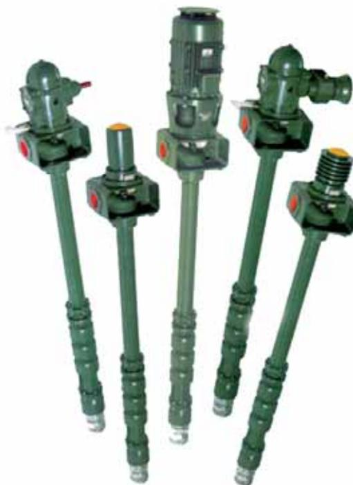
Гидравлическая часть, рабочие колеса и обратный клапан сделаны из чугуна, вал насоса сделан из закаленной стали с большим процентным содержанием хрома либо из нержавеющей стали, фильтр всасывающего патрубка сделан из оцинкованной стали.
