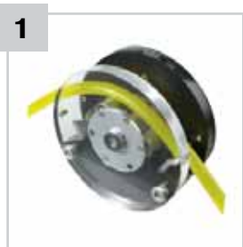
1 Положите трубку на ролики привода
