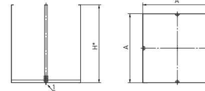
H\* — размер может при монтаже изменяться от 1050 до 1120 мм.
