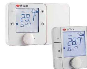
Графический терминал th-Tune используется вместе с программируемыми контроллерами с рСО mi! Предназначен для установки в помещениях с целью дистанционного управления температурой воздуха, а также для задания скорости вращения вентилятора\* и возможности задания определенного алгоритма включения и выключения установки по времени. Терминал оснащен встроенным датчиком температуры. Доступны модификации со скрытым и с настенным монтажом. Для работы терминала необходим источник питания.
