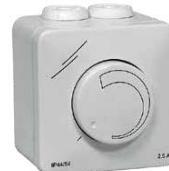
Электронные регуляторы оборотов RTY предназначены для регулирования оборотов однофазных двигателей вентиляторов путем плавного изменения подаваемого напряжения (фазное регулирование). Предназначены для настенного, а также для скрытого монтажа. Возможно одновременное подключение нескольких вентиляторов с учетом того, чтобы их суммарный потребляемый ток не превышал максимальный ток регулятора. Минимальное значение оборотов устанавливается внутренним потенциометром.
