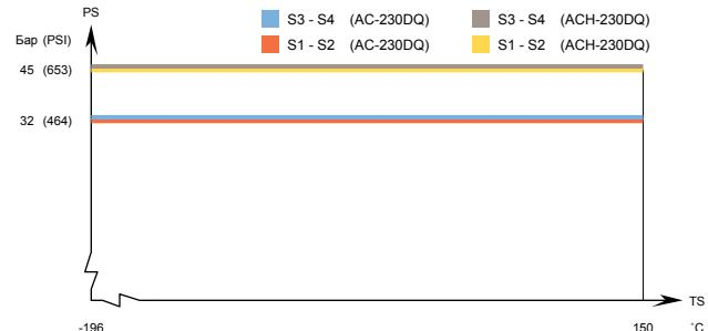
AC230DQ/ACH230DQ – график давления/температуры, сертификация UL
