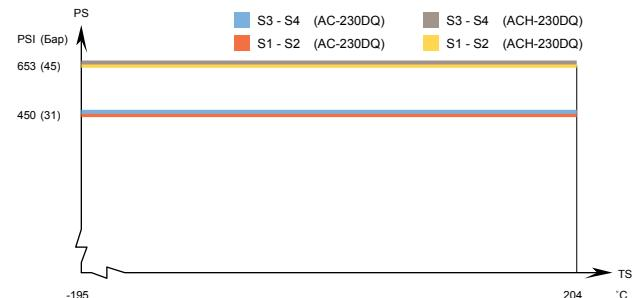
AC230DQ/ACH230EQ – график давления/температуры, сертификация PED
