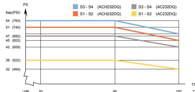
AC232DQ/ACH232DQ – график давления/температуры, сертификация UL
