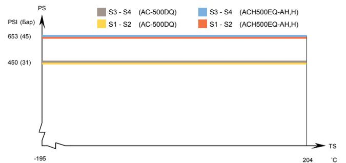
Предназначен для работы в условиях полного вакуума.
