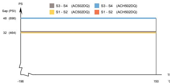
AC502DQ/ACH502DQ – график давления/температуры, сертификация UL
