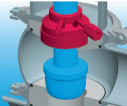
**Уплотнение шпинделя с гидрозатвором**
