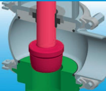
**Стандартный параболический конус с металлическим уплотнением**
