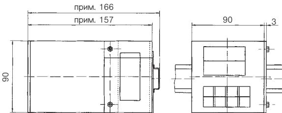
**Размеры** сменного блока MPC 19"
