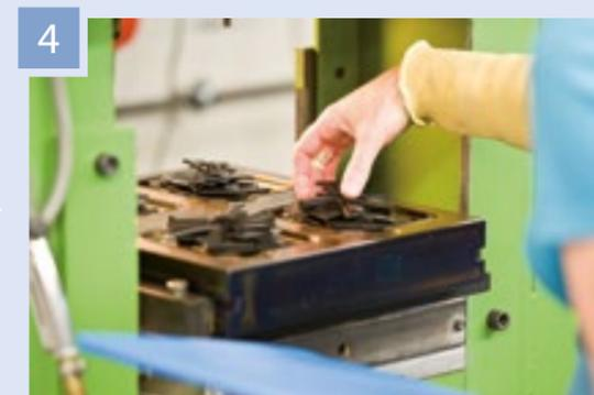
4 Вулканизационный пресс – заготовки из EPDM укладываются в формы.
