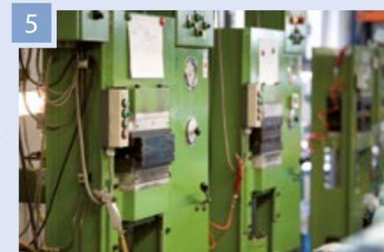
5 При вулканизации контролируются специфические производственные параметры (например, время, температура, давление и т.д.).
