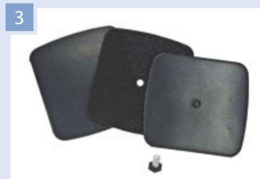
3 Сырье из EPDM, подготовленное к вулканизации, между двумя пластинами из EPDM тканевая прокладка.
