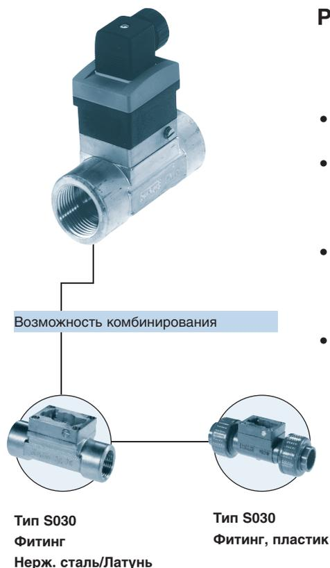
Расходомер ИНЛАЙН 8030 состоит из фитинга с крыльчаткой (S030) и электронного модуля (SE30). Вращение крыльчатки генерирует в сенсоре (в сенсоре Холла или индуктивной катушке) частотный сигнал, пропорциональный потоку. Сенсор может комбинироваться с другими приборами Бюрокерт, например, с расходомером/дозатором 8025 (панельное или настенное исполнения), импульсным преобразователем 8021, аналоговым преобразователем 8023 с последующей обработкой сигнала (например, на контроллер).
