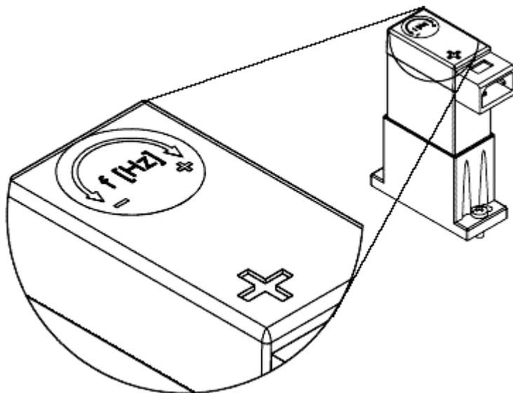
По запросу насос поставляется с частотным регулятором, встроенным в крышку насоса. Для изменения частоты следует просто вращать потенциометр в нужную сторону.
