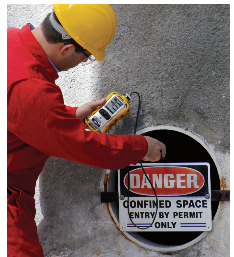
Тестирование в ограниченном пространстве с помощью MultiRAE Lite
