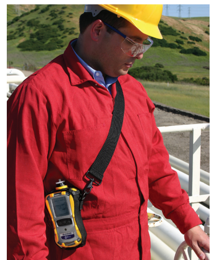
Устройство MultiRAE используется для контроля уровня вредных воздействий на работника на нефтеочистительном заводе
