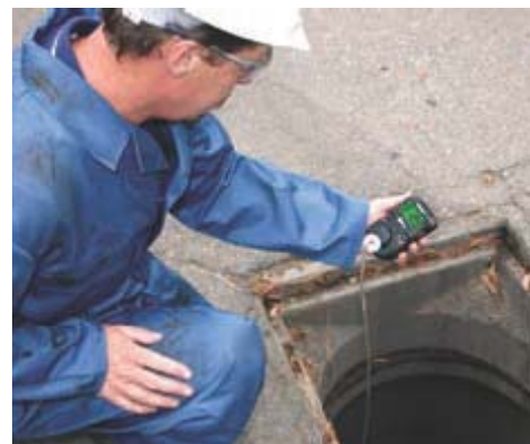
Газоанализатор QRAE II со встроенным электронасосом удобен при работе в труднодоступных и опасных местах
