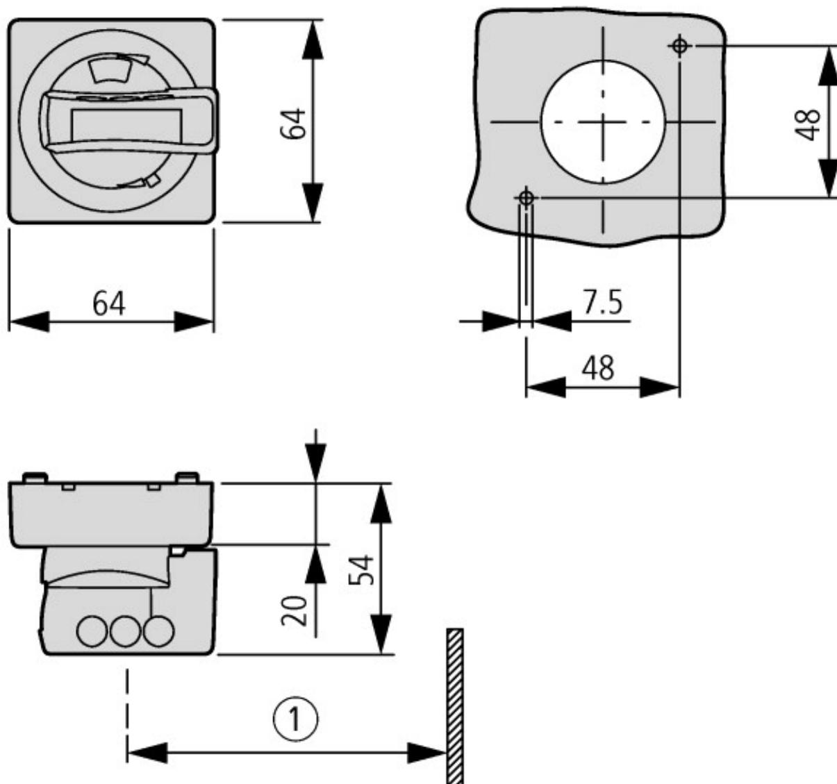
Глубина установки: от 125 до 240 мм от верхнего края DIN-рейки до переднего края двери шкафа/крышки
