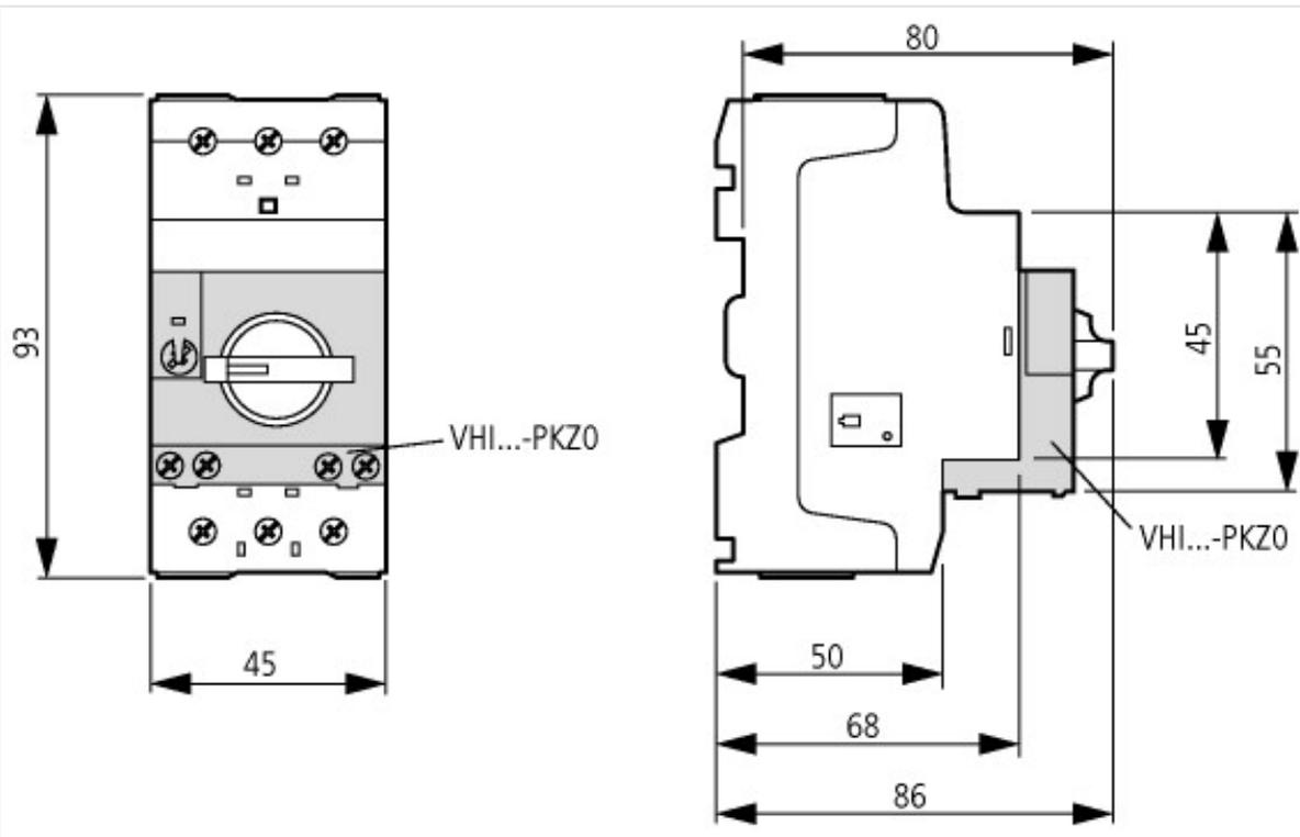
Автомат защиты двигателей с опережающим вспомогательным контактом
