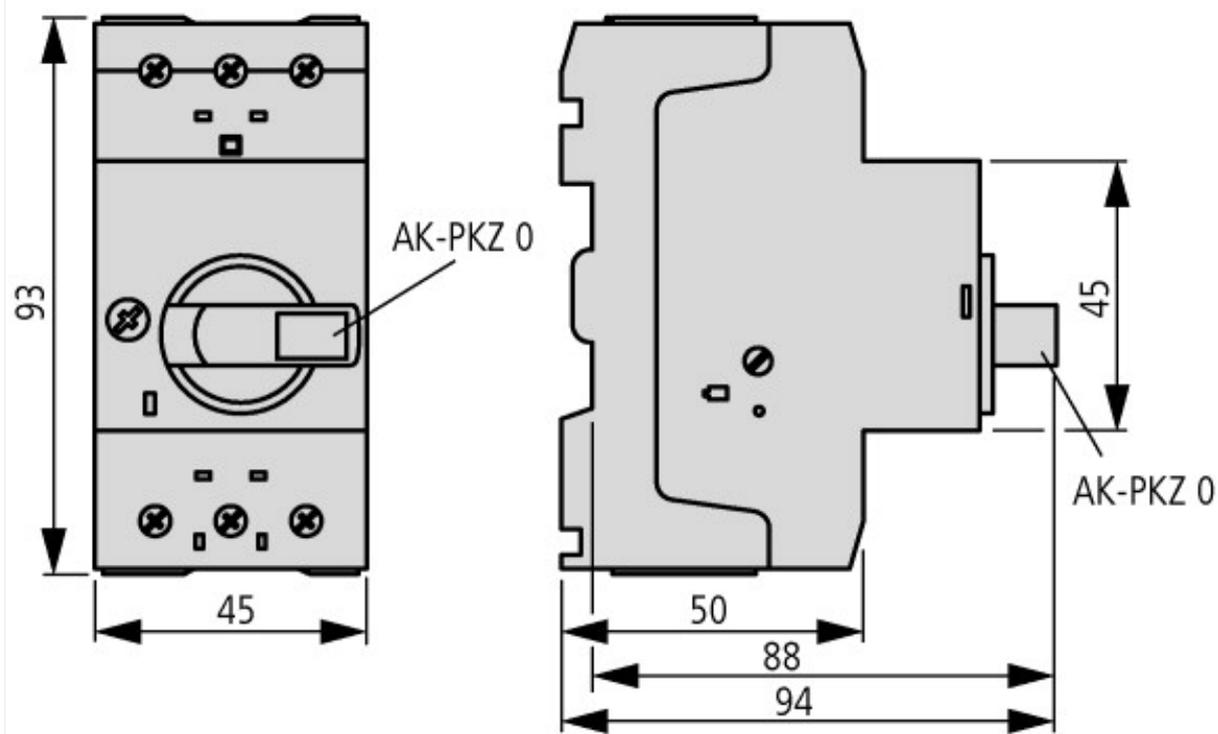
Автомат защиты двигателя с запираемой поворотной ручкой
