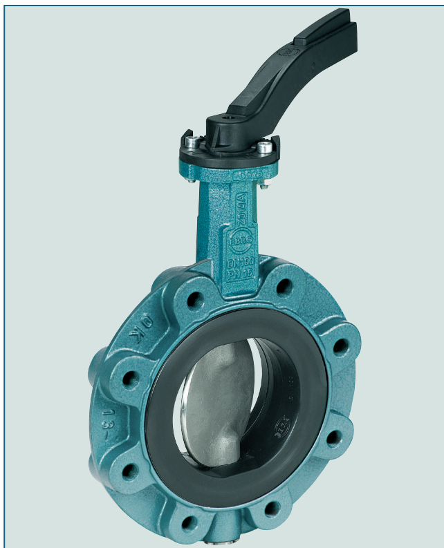
Фланцевый затвор с резьбовыми отверстиями. Данное исполнение позволяет производить одностороннее перекрытие трубопровода глухим фланцем.
