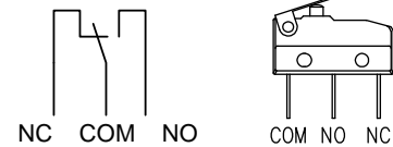
Диаграмма работы выключателей электропривода, находящийся в рабочем ходу при его среднем положении
