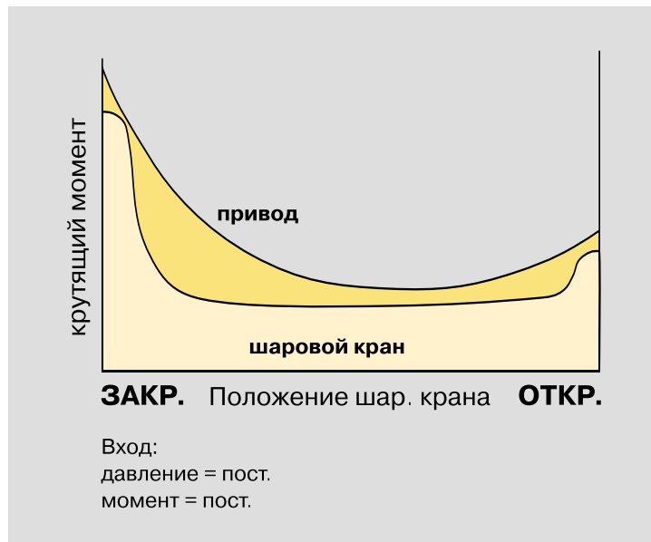
Принципиальная характеристика крутящего момента привода и шарового крана
