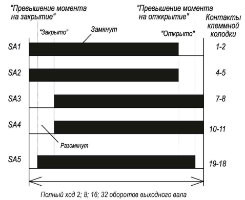
Диаграмма работы выходов сигнализации привода ЭП-3-100
