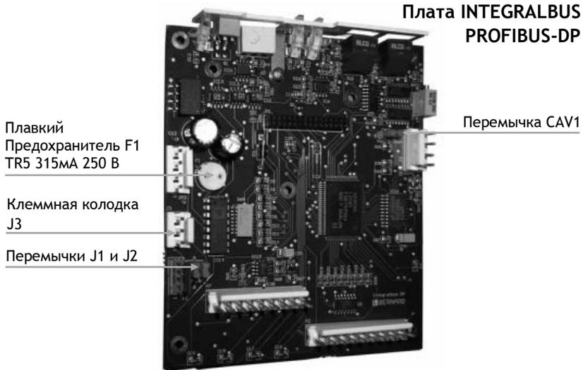
Доступ к плате (для установки адреса электропривода и настройки резистора в конце линии) осуществляется следующим образом: откройте кнопочную панель - для общепромышленной модели или откройте электронный блок - для взрывозащищенной модели.
