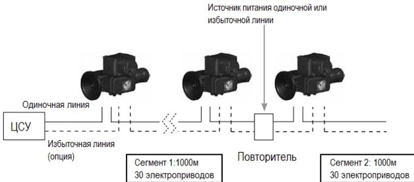
Повторители также могут использоваться для получения дополнительных дешевых линий полевой шины, если будут размещены на выходе ЦСУ (см. рисунок ниже).
