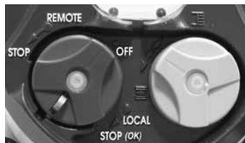
Синий селектор локального управления «открыть / закрыть» позволяет менять направление хода привода.
