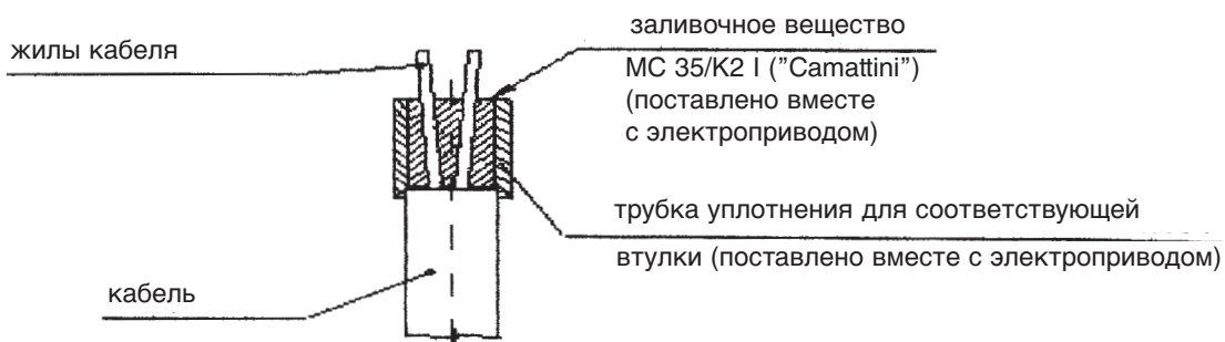
Рис. 5 – уплотнение жил кабеля заливочным веществом
