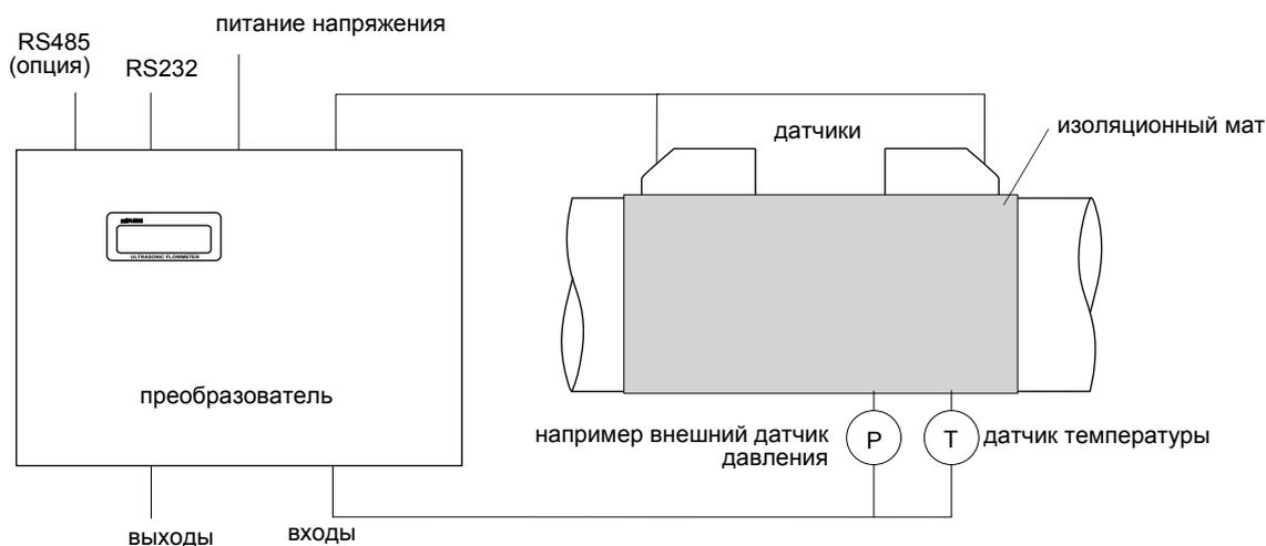
Пример расположения отражения с подключением входов к внешней системе измерения рабочего давления и температуры для расчета стандартного объемного расхода
