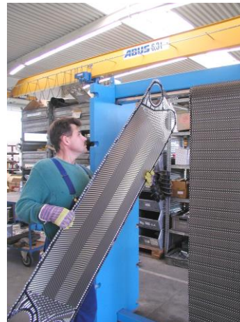
Рис 6.5. Демонтаж пластины с верхней направляющей.
