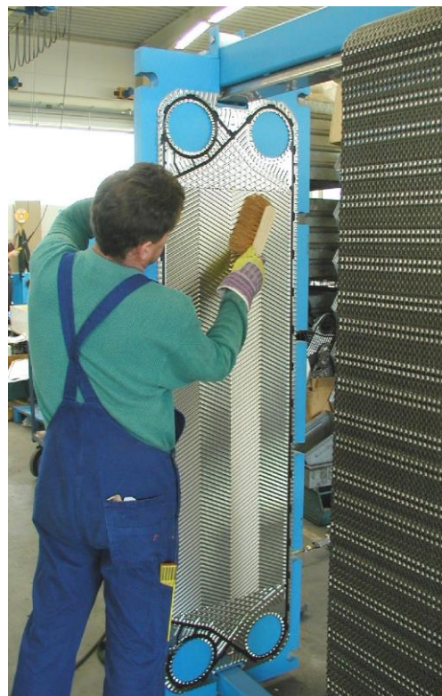
Рисунок 6.6. Очистка поверхности пластины с помощью мягкой щетки.
