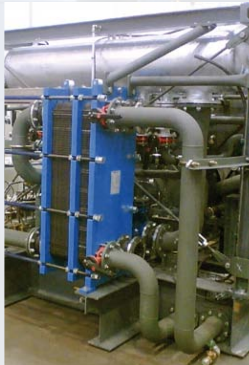
Охлаждение масла гидросистем для пневматических компрессоров в нефтеразведке
