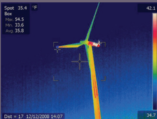
ИК-изображение ветровой турбины, полученное с земли
