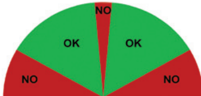
Рекомендуемый (зеленый) и нерекомендуемый (красный) углы съемки во время термографических осмотров.
